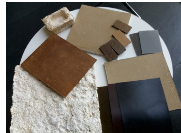
Samenvattend beeld van de verschillende materialen die getest zijn met vezels uit groenafval
